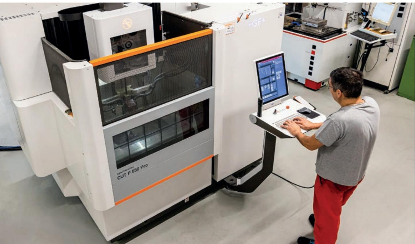
Die neue Drahterodiermaschine zur hochpräzisen Produktion von metallischen Werkzeugen und komplexen Formen.
