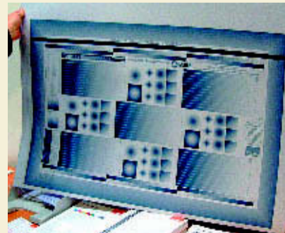
Die Fogra-CtP-Testform kann als Referenz für die Linearisierung von Belichtern zertifiziert werden.
