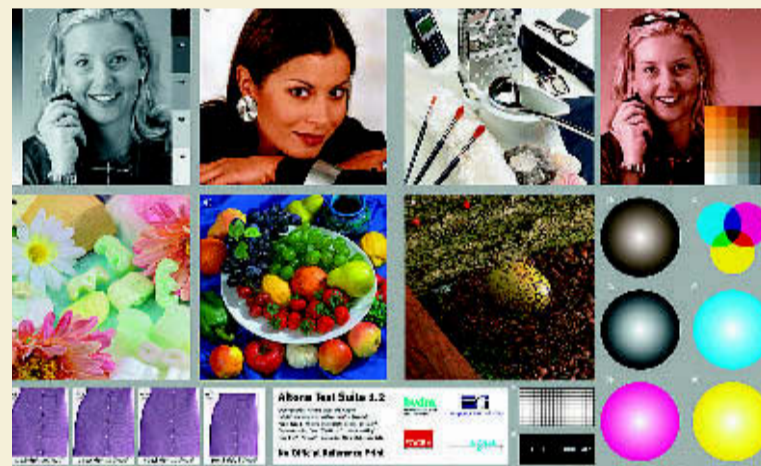
Die Altona Testform dient vor allem dazu, Raster-Image-Prozessoren (RIP) zu testen, die zu Proof-Geräten gehören.
