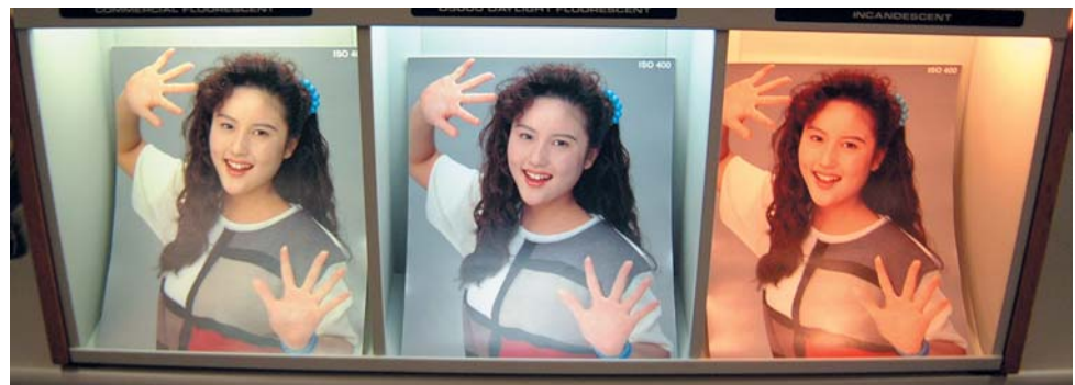
Gleicher Druck unter drei verschiedenen Beleuchtungen. Ganz rechts Glühlampenlicht von 3000 K, in der Mitte die Normbeleuchtung von 5000 K und links eine normale Fluoreszenzlampe von ca. 4000 K.
